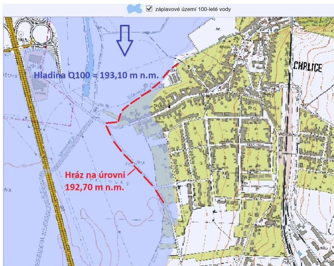
Obr. Situace při povodni Q 100 (Svitava, Svatka) s ohrázováním Chrlic na úrovni 192,70 m n.m. Hladina Q 100 na kótě 193,10.
