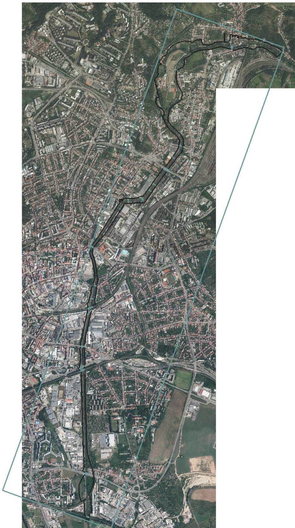
Obr. 6 Model Svitava (šedě – rozsah modelu, 2D objekty; černě – rozsah výpočtové oblasti)
