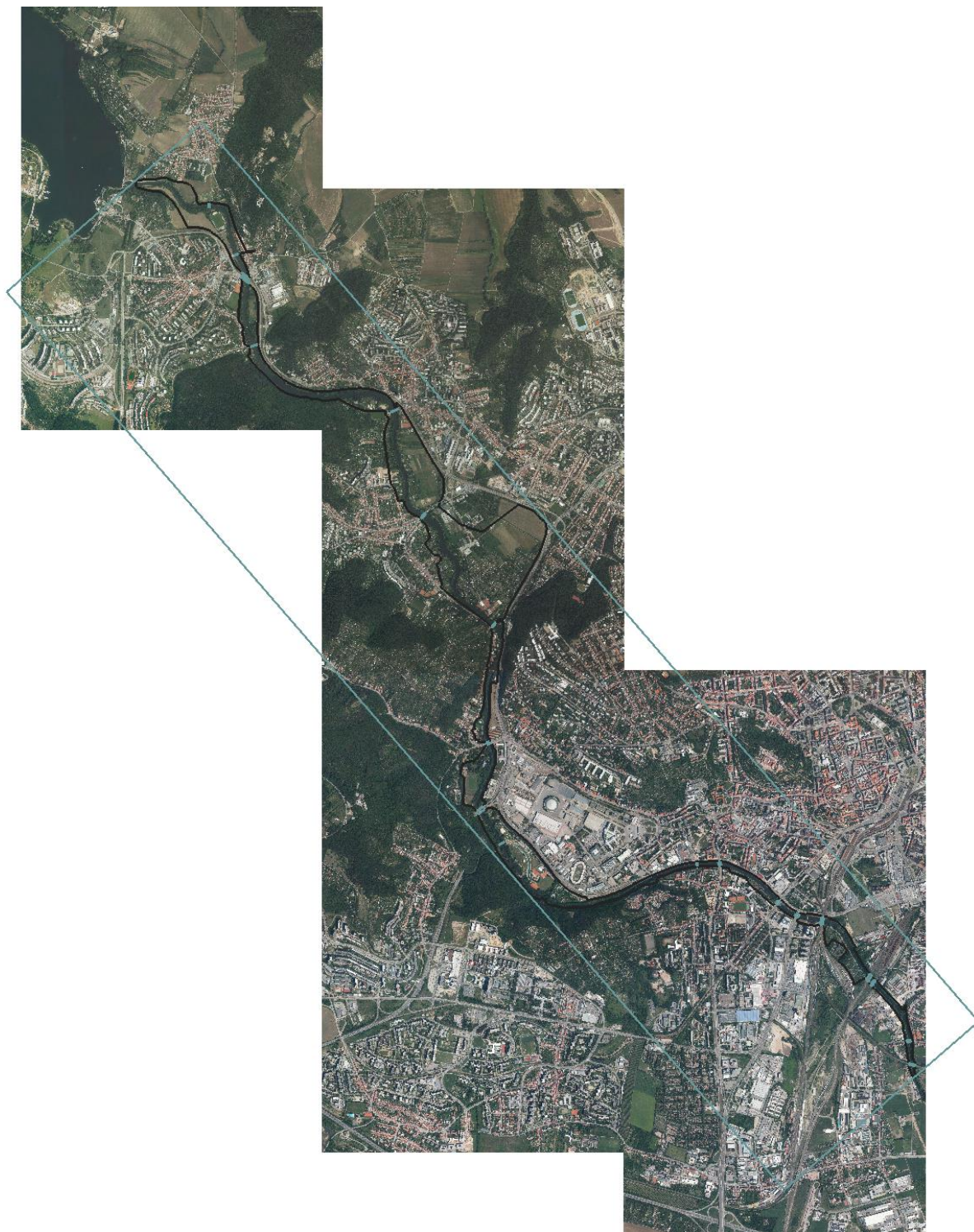
Obr. 7 Model Svratka (šedě – rozsah modelu, 2D objekty; černě – rozsah výpočtové oblasti)
